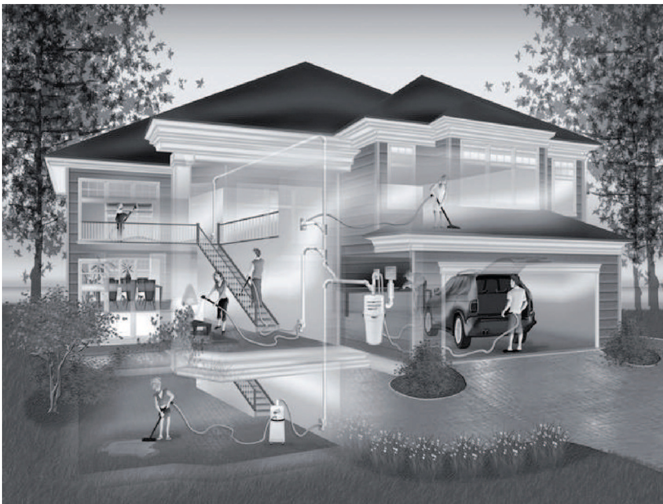
Rys. 2. Przykładowe rozmieszczenie gniazd ssących i jednostki centralnej.
